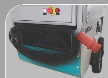
⑪ کابل سه فاز ۱۰ متری 10 meters 3 phase cable
