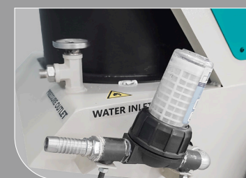
10 فیلتر آب ورودی Inlet Water Filter
