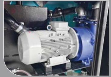
1 موتور الکتریکی مکش Electric Vacuum Motor
